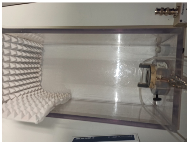
FIGURE 2.2 – Photo du dispositif exp rimental avec la cuve, le transducteur, la pi ce en impression 3D et le capillaire ainsi que l'absorbeur acoustique
