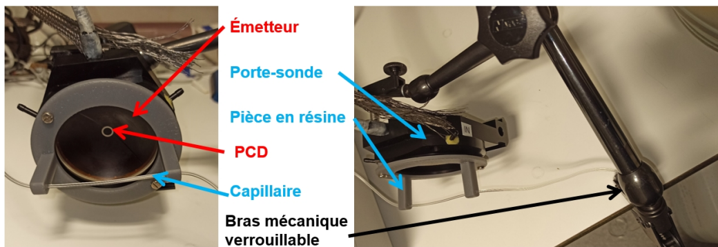
FIGURE 5.8 – Transducteur ultrasonore utilisé dans l'expérience de caractérisation de la cavitation à travers un demi crâne humain. Le transducteur est encastré dans un porte-sonde sur lequel est attaché la pièce en impression 3D permettant de positionner le capillaire dans la tache focale. Le bras mécanique verrouillable est lié au porte-sonde.
