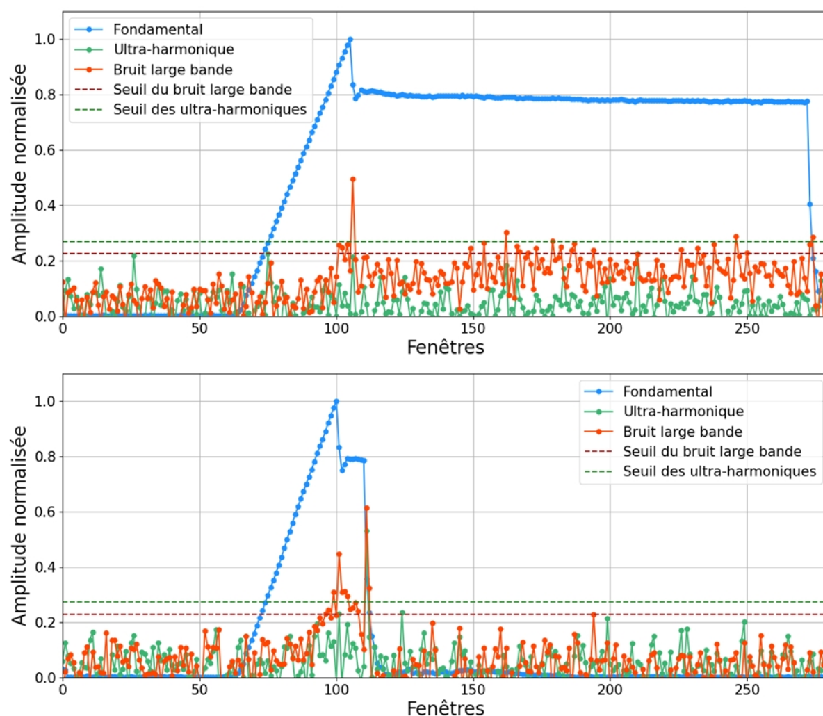
FIGURE 5.22 – Évolution temporelle de 2 tirs ultrasonores aux comportements différents. Sur le premier tir, la réduction de l'amplitude est observable après le dépassement de l'indice de bruit large bande. Après la réduction en pression, l'indice de bruit large bande diminue sans revenir à des valeurs aussi faibles que pour la première partie du tir. Dans le deuxième tir, après la réduction de l'amplitude, l'indice de bruit large bande ne diminue pas et le tir est alors interrompu.
